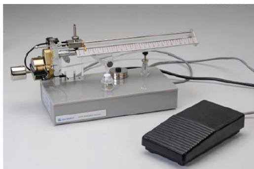
**Figura 22.** Analgesímetro utilizado para avaliar a hiperalgesia mecânica.
