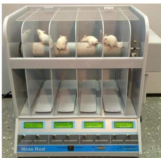
**Figura 26.** Aparelho da barra giratória (rota-rod) utilizado para avaliação da coordenação motora dos camundongos.
