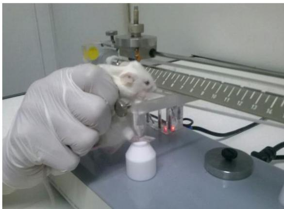
**Figura 23.** Avaliação da hiperalgesia mecânica usando analgesímetro
