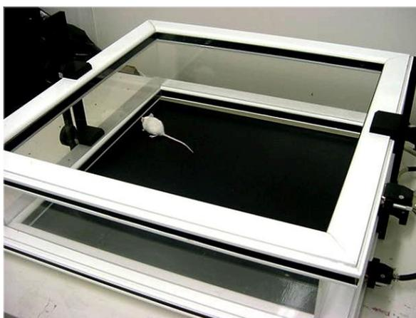
**Figura 25.** Câmara aberta (LE 8811 IR Motor activity monitor, Leticia<sup>®</sup>) utilizada para o teste de atividade sedativa
